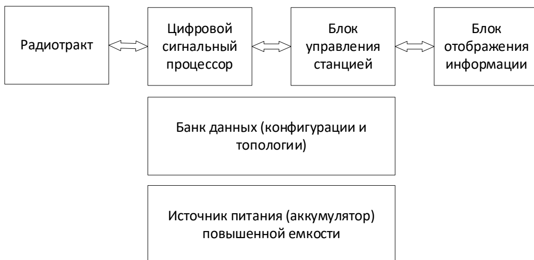
Рис. 5. Структурная схема абонентской станции
