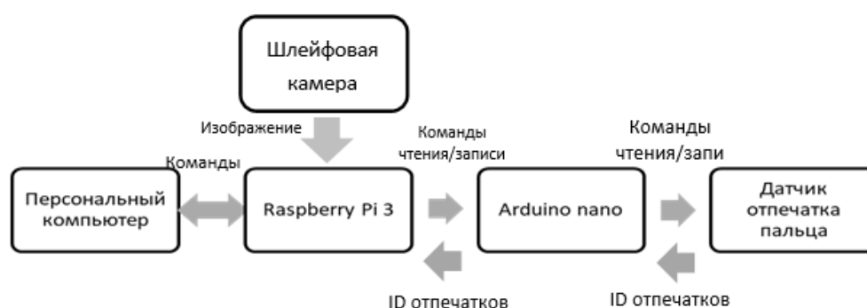
Рис.1 Схема блока аутентификации
