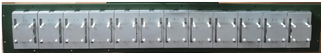
Рис. 2. Линейная эквидистантная антенная решетка из 12 щелевых излучателей с директорами в виде прямоугольных металлических пластин.
