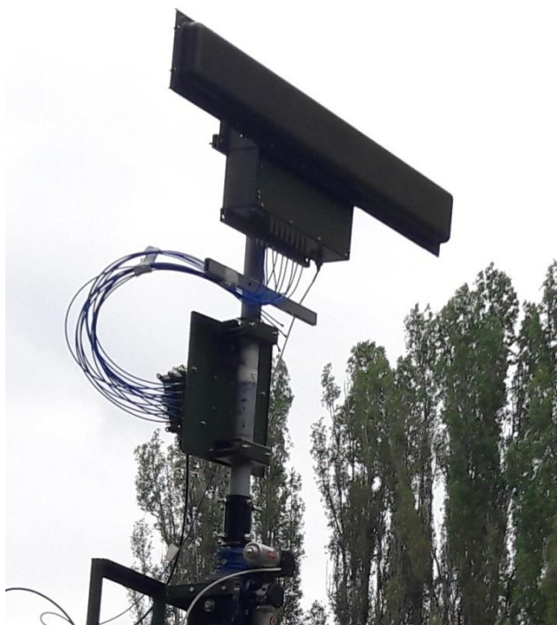
Рис. 1. Натурные испытания приемо-передающей антенной системы для перспективной базовой станции сотовой связи диапазона 1.8-1.88 ГГц
