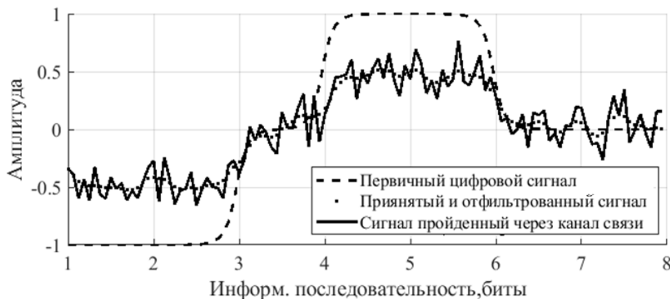
Рис. 3. Информационный сигнал с использованием двубинарного формата.
