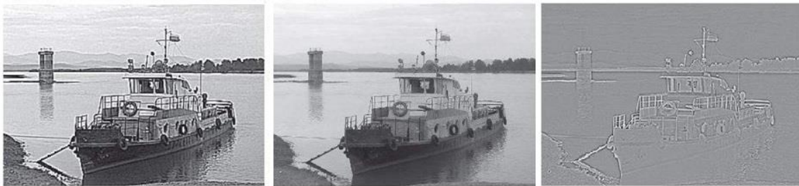
Рис. 2. Двухступенчатая фильтрация входного снимка (сцены) матрицей Собеля
