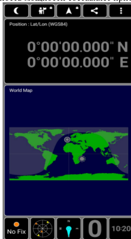
Рис. 2. Результат подавления сигнала GPS
