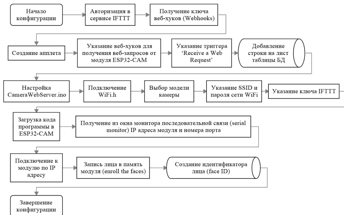
Рис. 5. Блок-схема программного алгоритма конфигурации системы идентификации лиц
