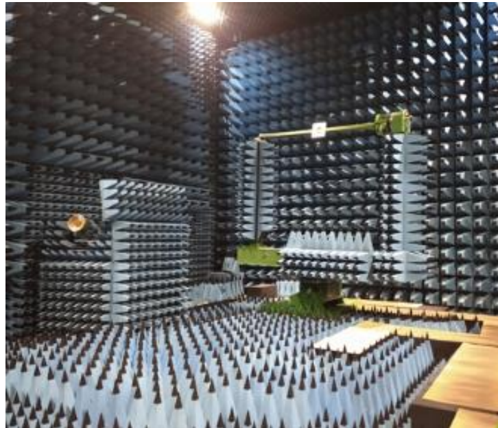
Рис. 3. Внешний вид одного из эталонных комплексов измерений ЭПР, США
