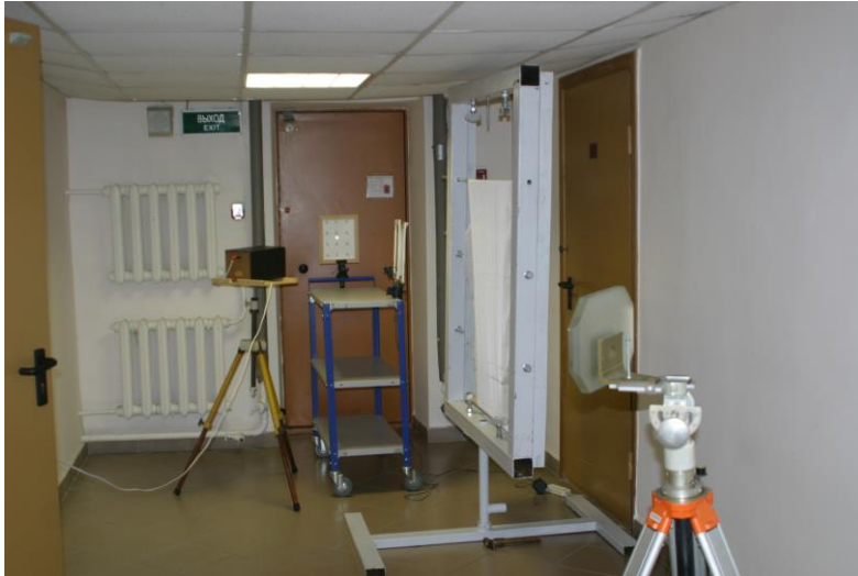
Рис. 1. Общий вид экспериментальной установки по определению влияния вуалей на регистрацию АРИ с тестовой мишени.
