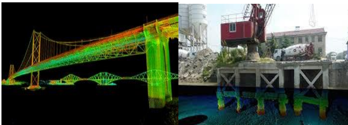
Рис. 2. Сканирование при помощи LiDAR
