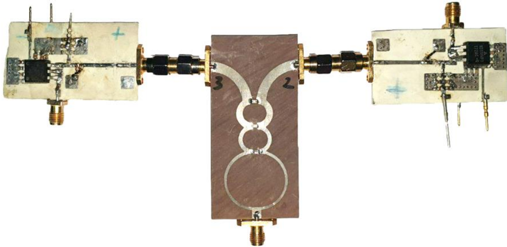
Рис. 3. Внешний вид реконфигурируемого генератора СКИ с двумя генераторами импульсов колокольной формы и трехзвенным сумматором Уилкинсона.
