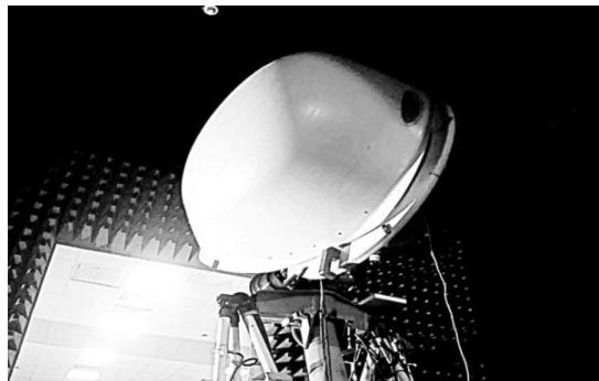
Рис. 9. Общий вид измерительного комплекса с установленной под РПО (с произвольным углом крена \Psi ) тестовой ФАР
