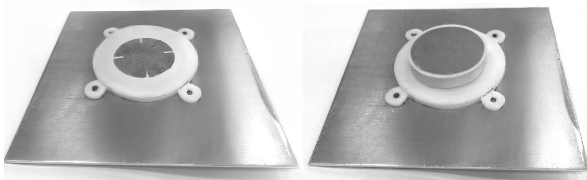
Рис. 4. Экспериментальный образец антенны
