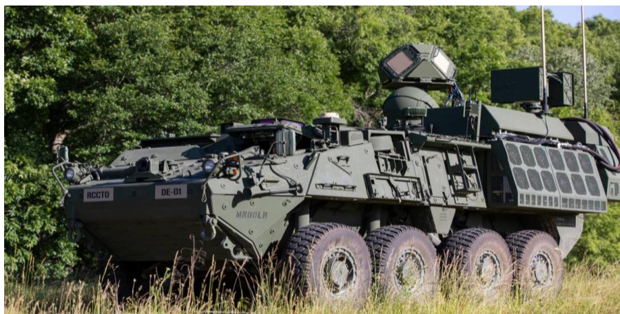
Рис. 10. Опытный образец мобильных лазерных систем ПВО малой дальности DE M-SHORAD
