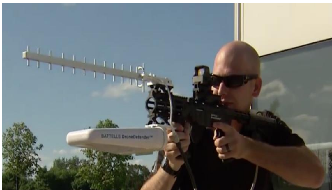
Рис. 4. Первая упомянутая в мировых СМИ винтовка для противодействия БВС – американский антидрон Battelle AntiDrone
