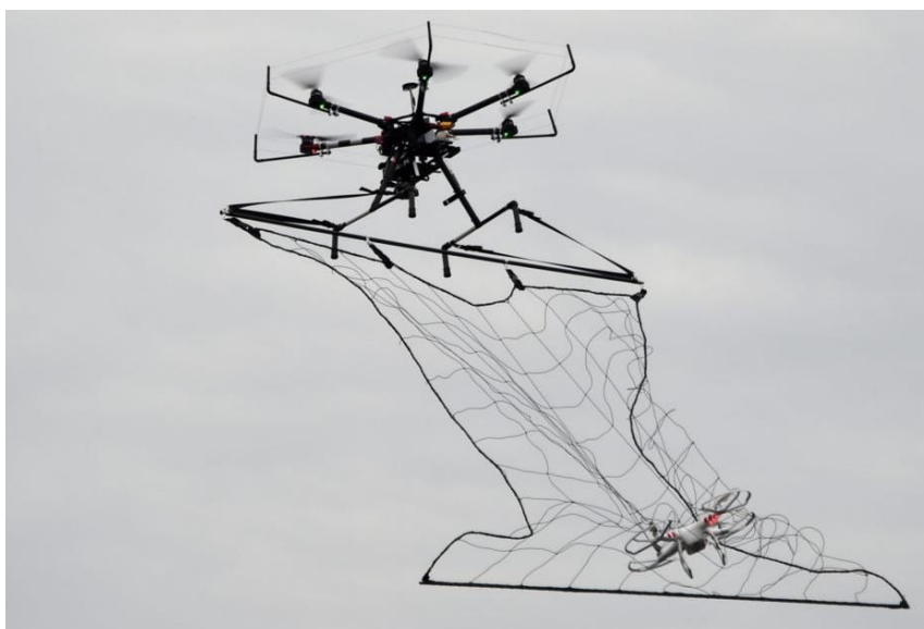
Рис. 7. Японский перехватчик с сетью для борьбы с малыми БВС
