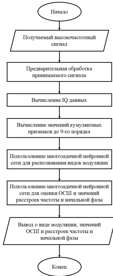
Рис. 3. Обобщённый алгоритм распознавания видов модуляции, оценки отношения сигнал/шум (ОСШ) и значений расстроек частоты или начальной фазы.
