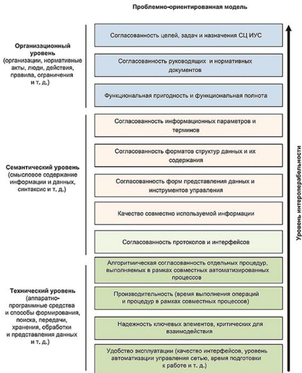
Рис. 2. Типовая проблемно-ориентированная модель СЦИУС согласно ГОСТ Р 70569-2022
