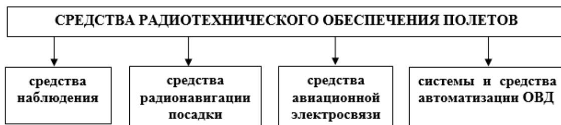
Рис. 3. Классификация средств радиотехнического обеспечения полетов
