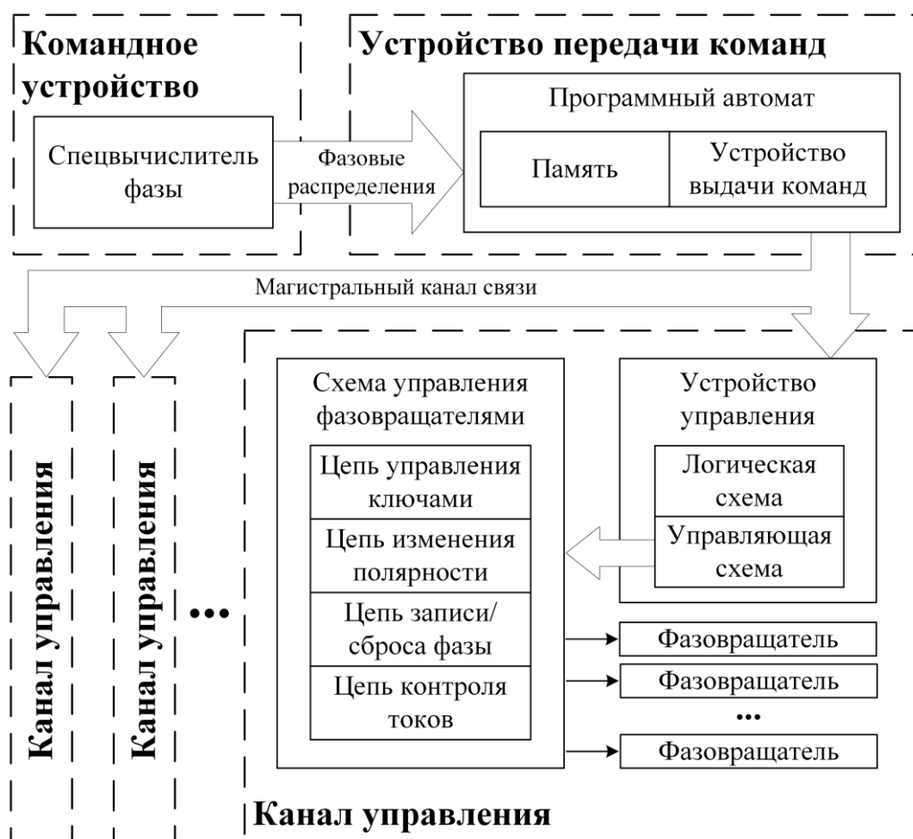
Рис. 1. Обобщенная структурная схема СУЛ ФАР.
