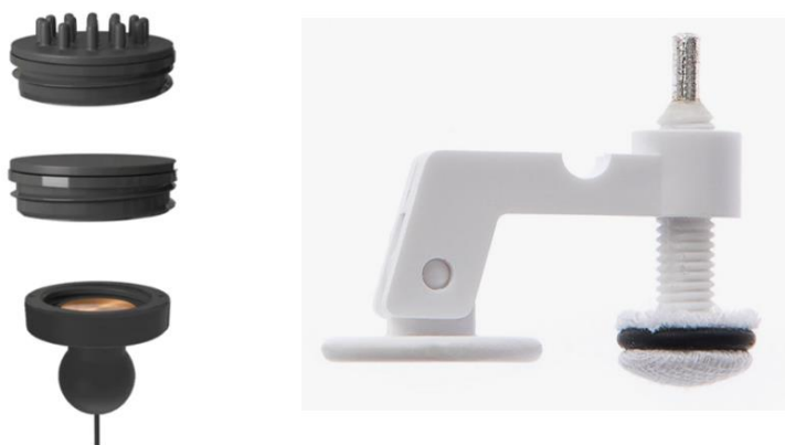
Рис. 1. Активный (слева) от OpenBCI и пассивный (справа) мостиковый электроды
