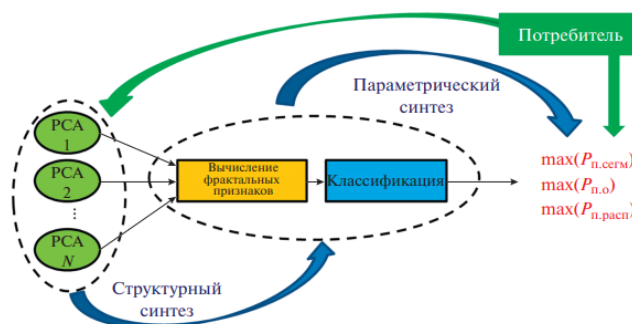
Рис. 9. Схема структурно-параметрического синтеза системы ТТФО многомерных РЛИ ( P_{п.сегм} , P_{п.о} , P_{п.расп} – вероятности правильной сегментации, обнаружения и распознавания соответственно).
