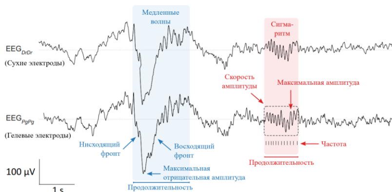
Рис. 6. ЭЭГ данные субъекта, записанные во время сна с использованием сухих (сверху) и гелевых (снизу) датчиков.
