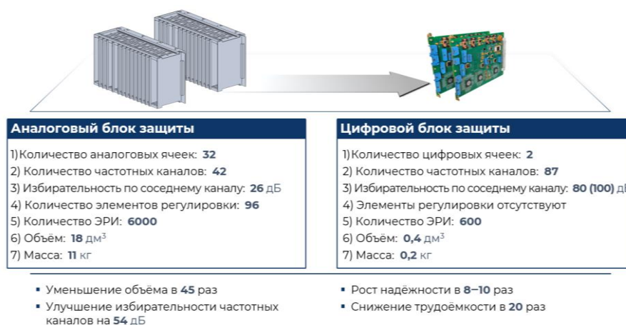
Рис. 3. Преимущества технологии программно-определяемого радио
