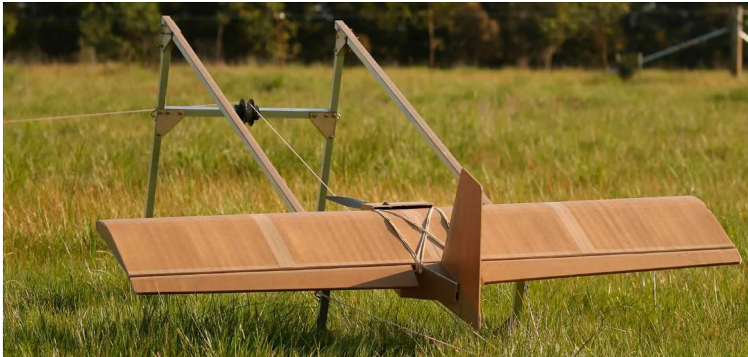
Рис. 1. БВС Corvo PPDS на катапульте для запуска
