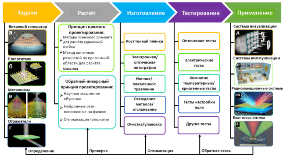
Рис. 16. Обзор типичного процесса исследования метаповерхности [41].
