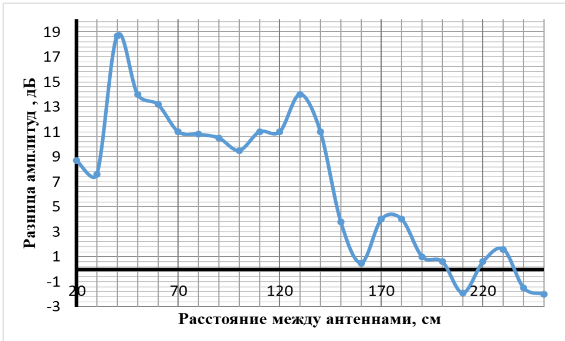
Рис. 4. Зависимость разницы амплитуд от дальности
