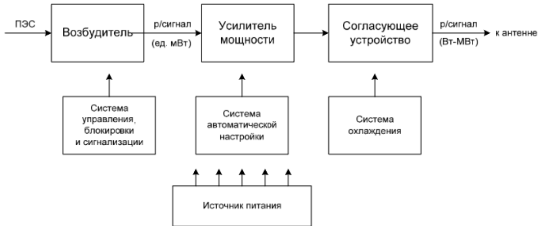
Рис. 2. Типовая структурная схема современного радиопередатчика
