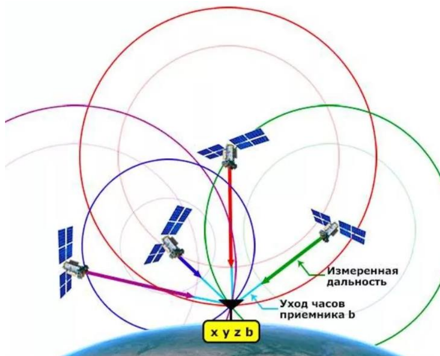
Рис. 1. Принцип работы ГНСС с наземным приемным устройством
