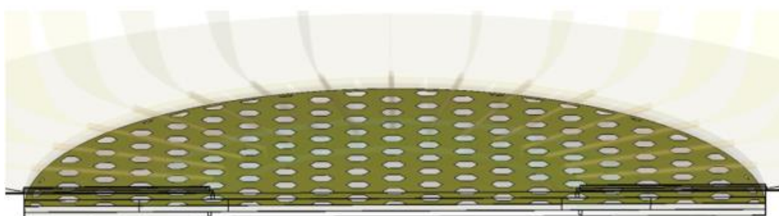
Рис. 3. Модель антенной системы. Перфорированный экран, разделяющий тело плоской линзы Лüneберга на две области: запитывающей элементы антенной решетки, и подключенной к диаграммообразующим портам антенной системы.
