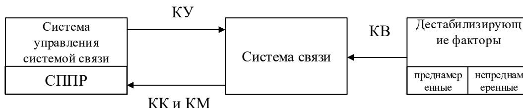
Рис. 1. Обобщенная модель функционирования СУ СС в условиях воздействия ДФ
