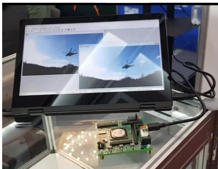
Рис. 9. Демонстрация работы одноплатного вычислительного модуля СМ 121.01
