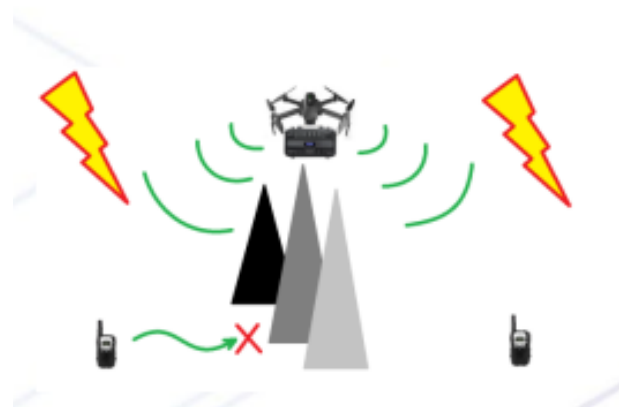
Рис. 1. Подход к увеличению дальности радиосвязи с использованием БПЛА
