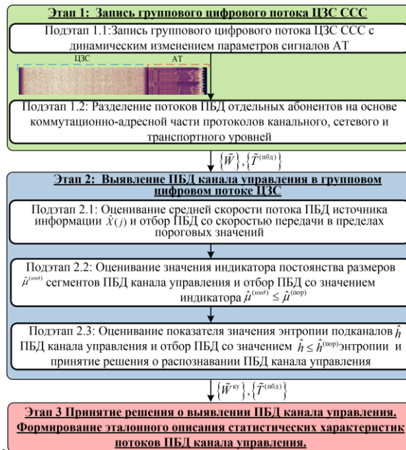
Рис. 2. Этапы метода выявления ПБД канала управления в групповом цифровом потоке ЦЗС ССС с динамическим изменением параметров сигналов АТ.
