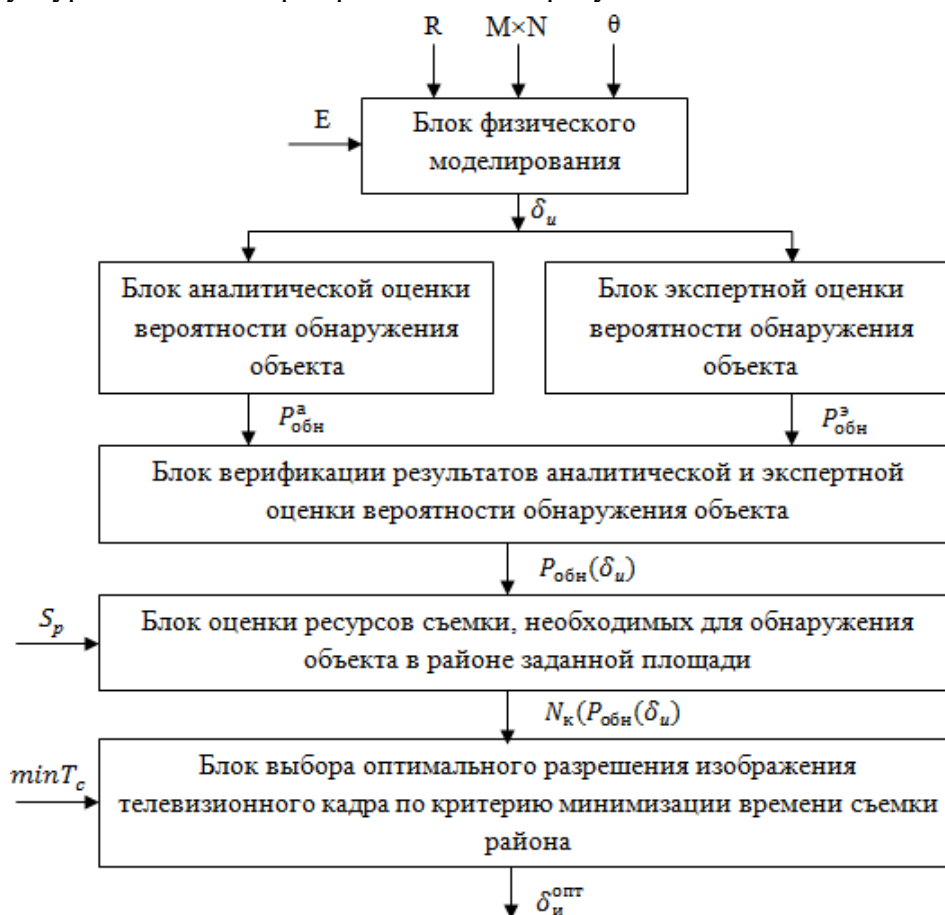
Рис. 4. Структура модели выбора оптимального разрешения изображения телевизионного кадра по критерию минимизации времени съемки
