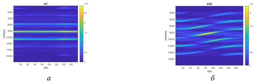
Рис. 5. Приемно-передающие диаграммы направленности: *a* – после согласованной фильтрации (С); *б* – после несогласованной фильтрации (С0).
