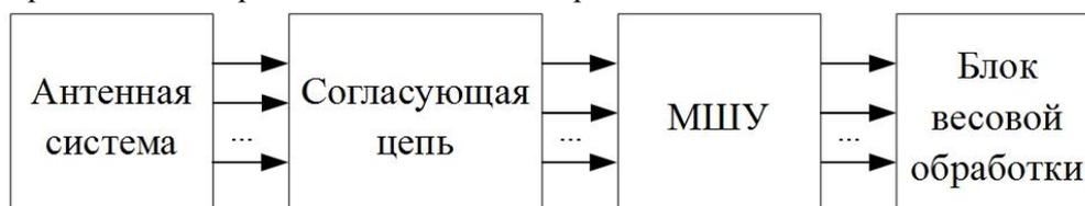
Рис. 1. Структурная схема многоканальной радиосистемы.
