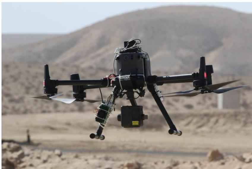
Рис. 2. Серийный дрон с камерой и ПО NavSight.
