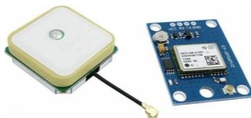
Рис. 4. Модуль GPS Neo-6M
