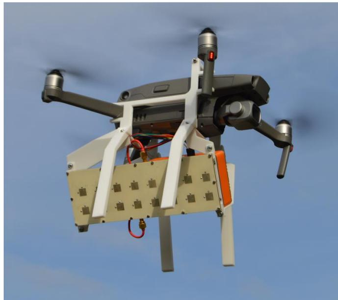
Рис. 4. Однобитный РСА установленный на Mavic Pro 2
