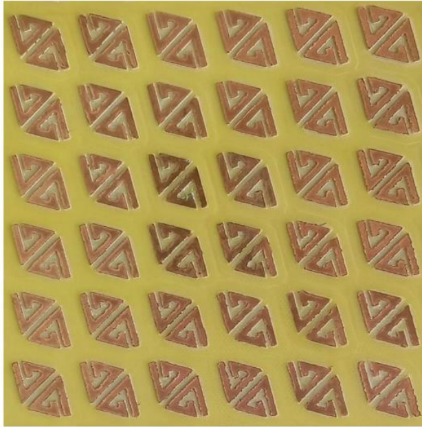
Рис. 1. Метаструктура типа спиралевидный треугольник.
