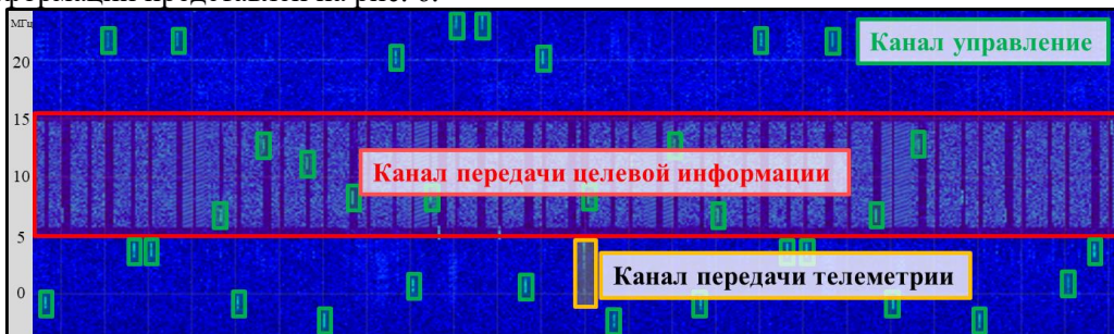
Рис. 6. Частотно-временная структура OFDM сигнала
