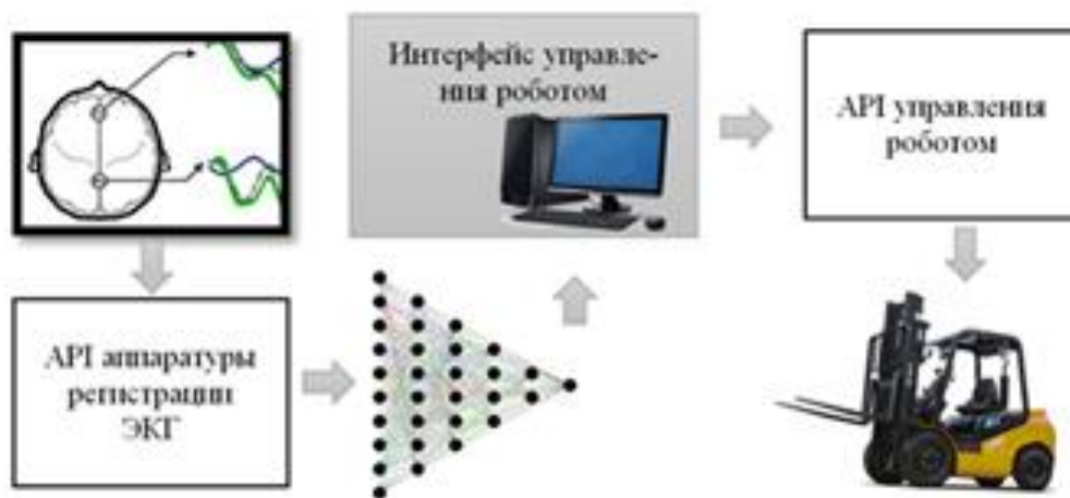
Рис. 4. Общая схема управления роботом через управляющее воздействие оператора
