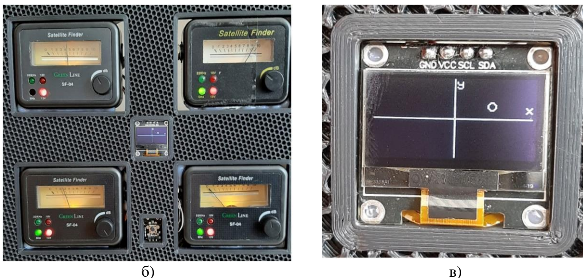
Рис. 6. Лабораторная установка системы наведения на воздушную цель: а) общий вид установки; б) вид панели органов управления; в) вид индикатора направления на цель.
