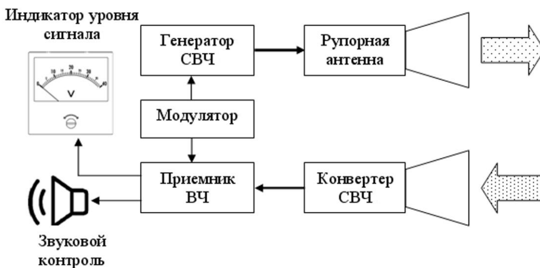
Рис. 3. Структурная схема генератора СВЧ подсветки цели с устройством наведения.
